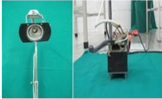
Figura 4. Lámpara de reconocimiento modificada con bombilla de halógeno.
